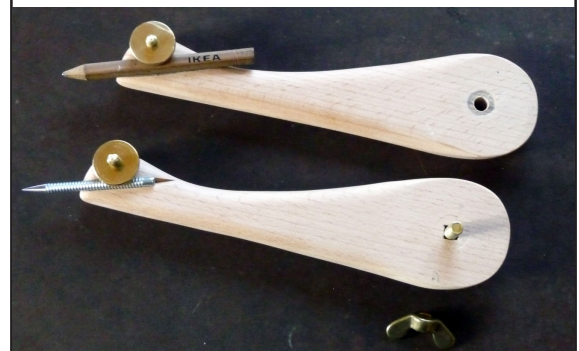
Ein geriffelter Stahlnagel wird als Zirkelspitze verwendet. Dazu wird der Kopf abgesägt, ein Ende wird mit Feile und Schleifstein kegelig angespitzt, das andere flach gerundet.
