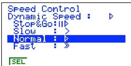
Die einzelnen Felder [Stop&Go], [Slow], [Normal] und [Fast] werden mit den Pfeiltasten  $\blacktriangle$  bzw.  $\blacktriangledown$  angesteuert und mit der Funktionstaste  $F1$  ausgewählt.
